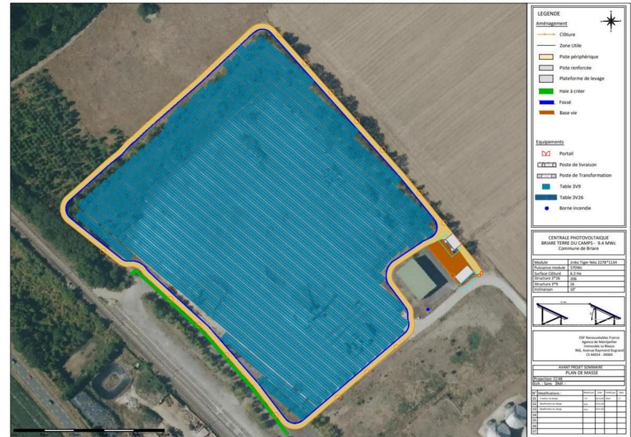
Figure 148 : Plan de masse du projet – Solution retenue (Source : EDF renouvelables)
